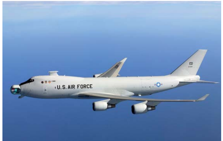
Het Airborne Laser Testbed. De spiegel waarmee de bundel op het doel gericht wordt bevindt zich in de neus
