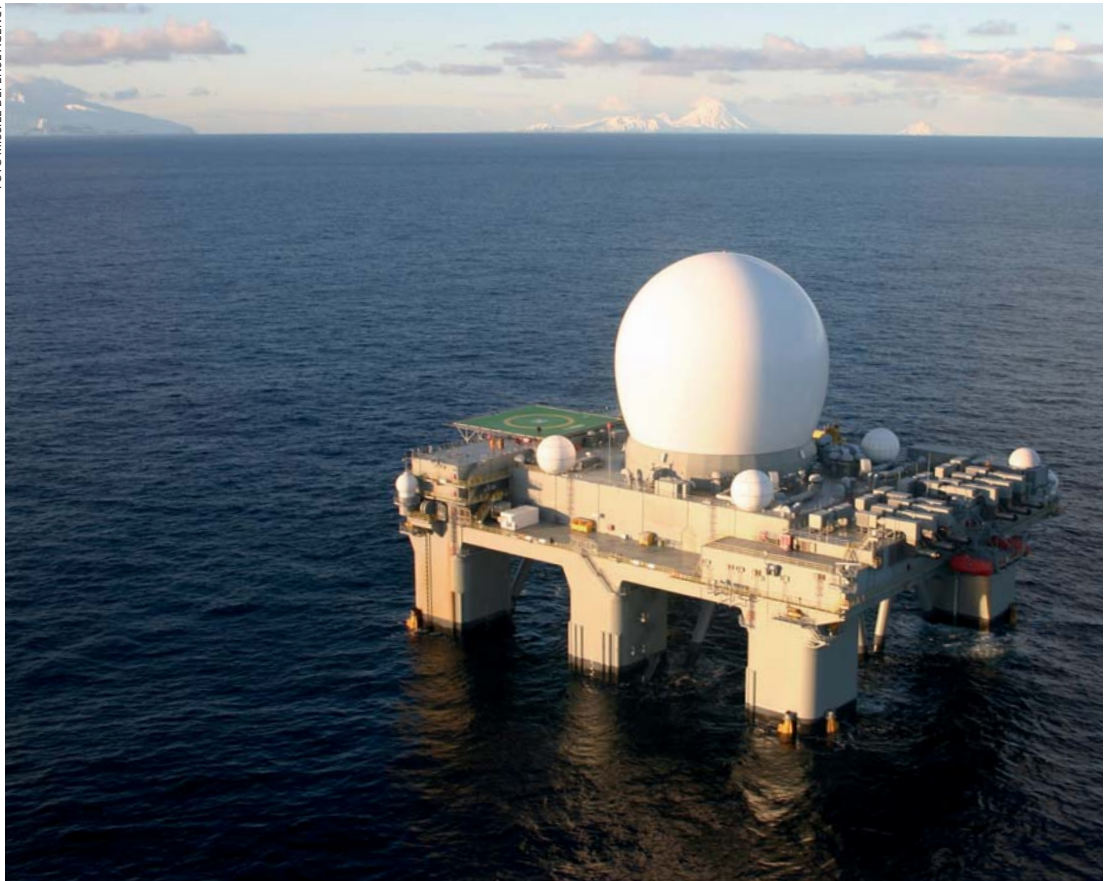
Een op zee gestationeerde Amerikaanse X-Band radar voor het opsporen van ballistische raketten
