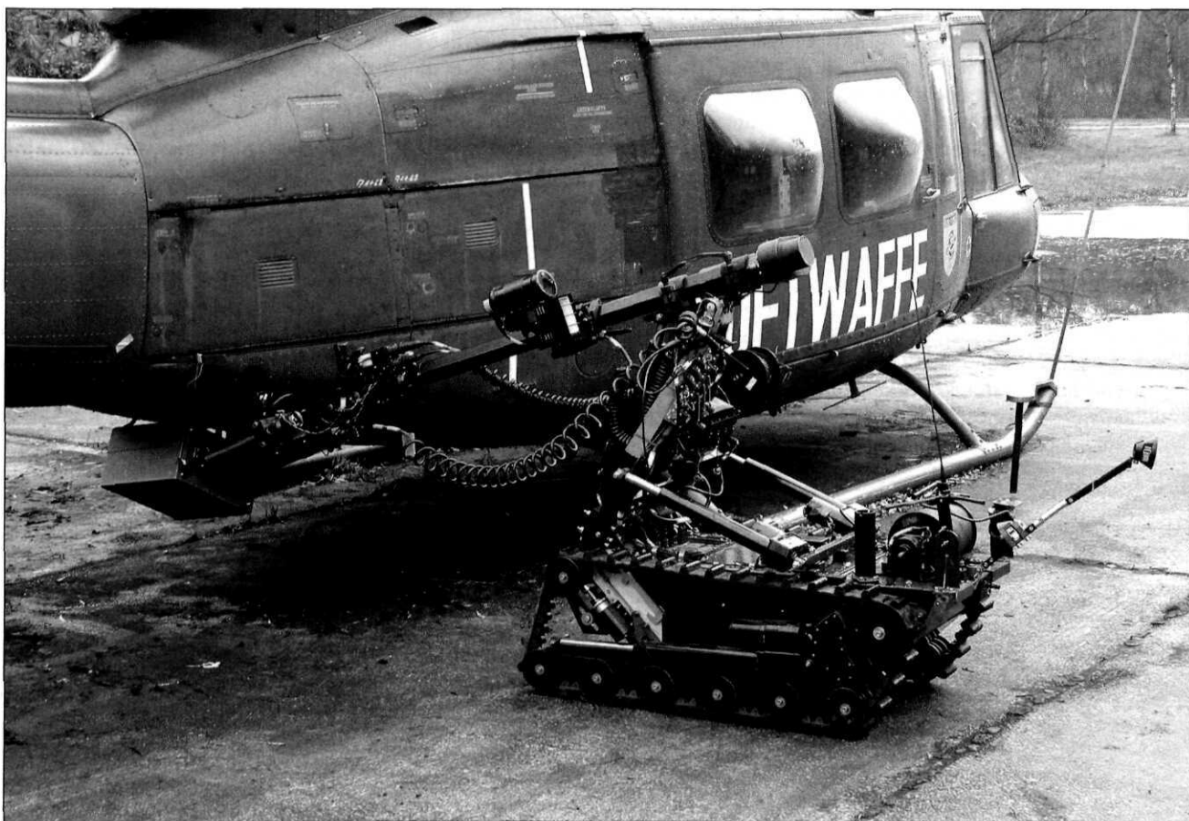
Inzet van een robotsysteem tijdens een oefening om geïmproviseerde explosieven onschadelijk te maken, Duitsland, 2003 (Foto: IMG/KL, J. van Woensel)
