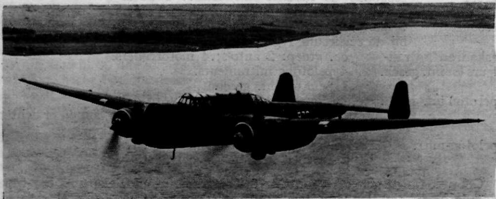
Tweemotorig bomvliegtuig, uitgerust met Bristol Hercules motoren, bestemd voor de Nederlandsch-Indische Militaire Luchtvaart. De Fokker T. 9 is het eerste geheel metalen vliegtuig naar Nederlandsch ontwerp.
