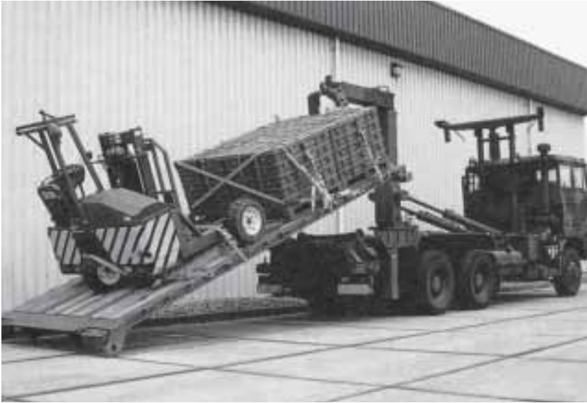
Een wls met flatrack, het onafhankelijk lastdragerconcept
