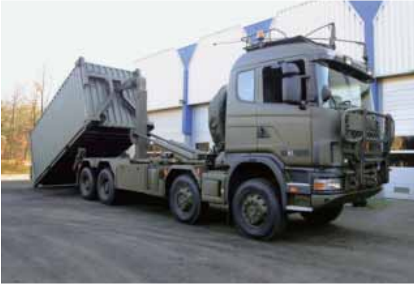
De firma's Daimler-Benz en Scania hebben beide een wissellaadsysteem voor containers bedacht. De Scania geeft een demonstratie (Foto Mindef, D.V.; collectie NIMH)
