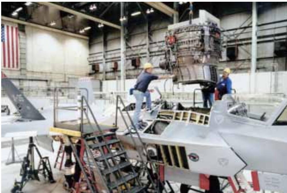
Plaatsing van een zgn. LiftFan in een Joint Strike Fighter bij Lockheed Martin
