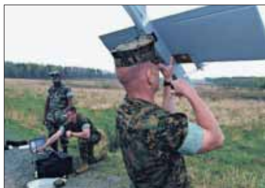
Amerikaanse mariniers testen een UAV (de 'Dragon Eye') waarmee ze over de volgende heuvel kunnen zien
