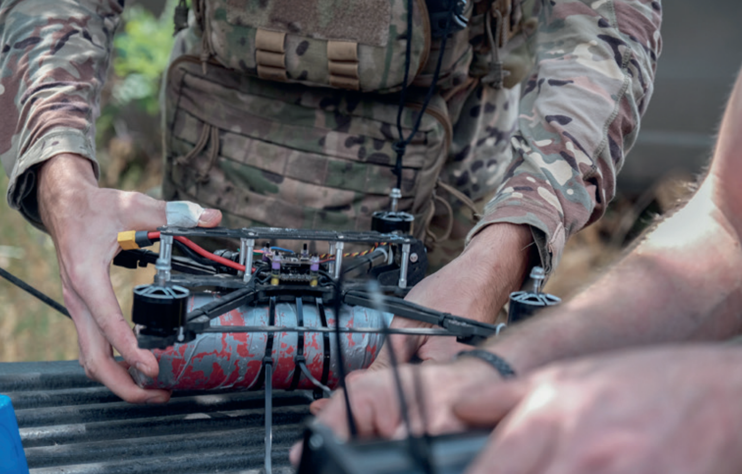
Oekraïense militairen oefenen met fibre-optic FPV's. Deze draadgeleide UAS kunnen niet verstoord worden met EO/VS-maatregelen
