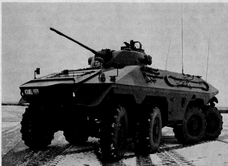
Afb. 2 Westduitse Spähpanzer Nr 2, amfibisch, met o.m. een bemanning van 4 personen en een 20 mm snelvuurkanon
