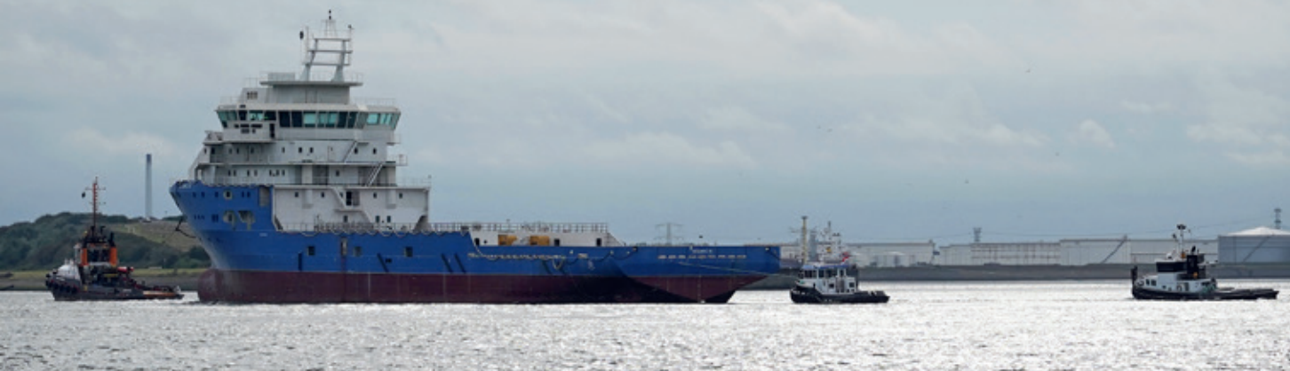
Het OSV Oceanic III bij Hoek van Holland. OSV's zijn herkenbaar aan het vooropgeplaatste brug- en accommodatiecomplex en het grote achterdek, waar gemakkelijk een containerversie van sonar op geplaatst zou kunnen worden
