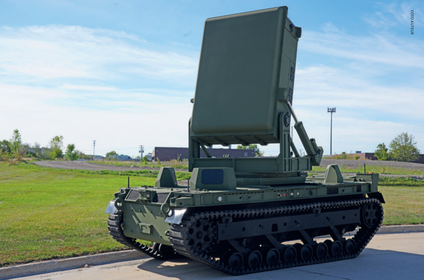
Leonidas is een gevanceerd antidrone-wapensysteem gebaseerd op high-power microwave (HPM) technologie
