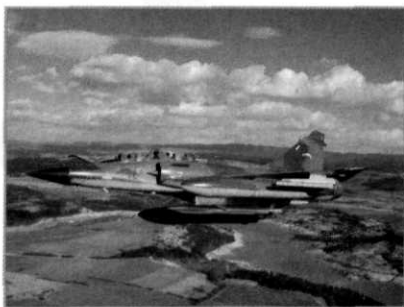
Mirage 2000N met ASMP-nucleaire missies (bevestigd aan middenpilon)
