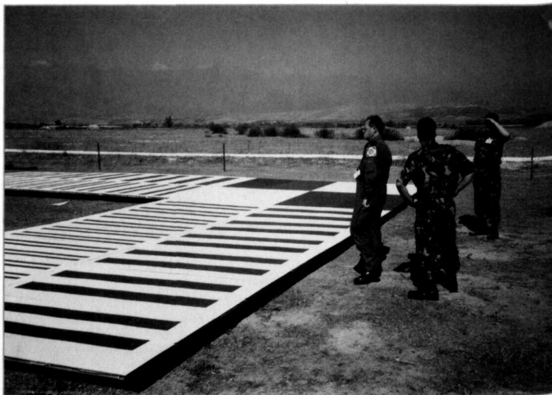
Afb. 4 Lay-out van het calibratie-target voor het testen van de sensoren van het COPS en het nauwkeurig bepalen van de filmgevoeligheid; tevens voor het berekenen van de te vliegen hoogte voor het verkrijgen van een minimale resolutie van dertig centimeter, conform het 'Open Skies'-verdrag
