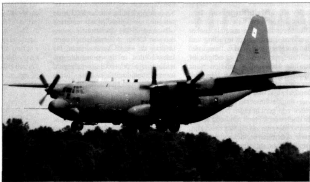
Afb. 8 De Hercules van het type C-130 is een tactisch transportvliegtuig met een grote actieradius, dat geschikt is voor landingen op korte en onverharde vliegstrips. Hier is een afgeleide versie afgebeeld: AC-130H Spectre gunship (Foto: Jane's)
