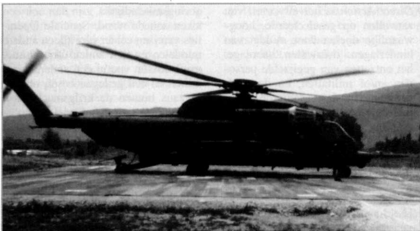
Afb. 2 Een door de Amerikanen gebruikte helikopter van het type CH-53. Hier is afgebeeld een zogenaamde Pave Low versie, speciaal geschikt gemaakt voor inzet van speciale eenheden (Foto: Jane's)
