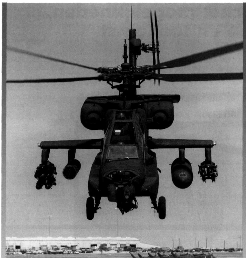
Afb. 2 AH-64A. Duidelijk zichtbaar zijn de vier ophangpunten met Hellfire-raketten Rocketpod en extra brandstoftank
