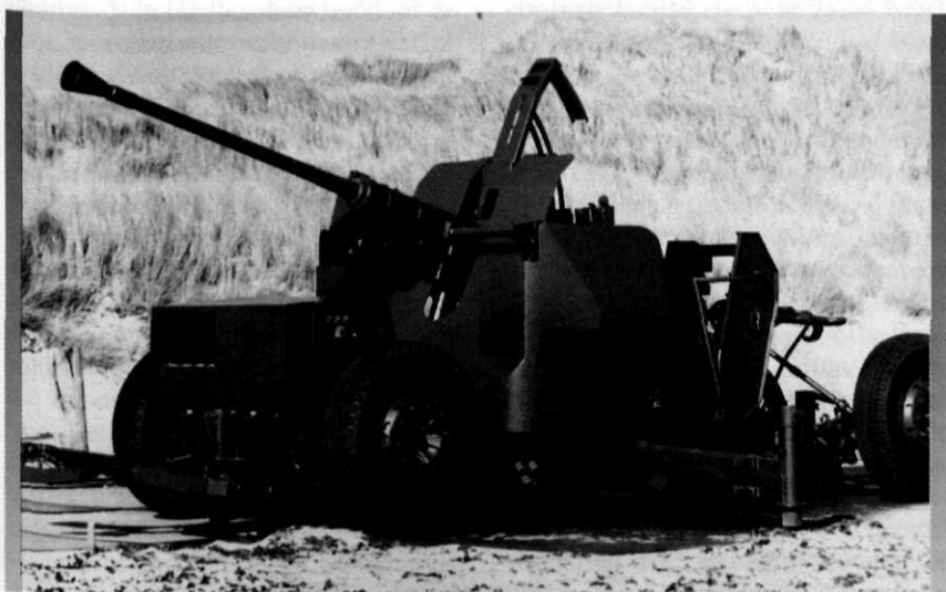
Afb. 3a/3b De Flycatcher radarvuurleidingsinstallatie en twee vuurmonden met kaliber 40 mm vormen samen één kanonsysteem. De munitie is voorzien van een nabijheidsbuis. De radar en de vuurmonden staan elk op een onderstel en worden door een KL standaard voertuig getrokken. Het systeem is ingevoerd vanaf 1990.
