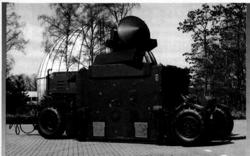
Afb. 3a/3b De Flycatcher radarvuurleidingsinstallatie en twee vuurmonden met kaliber 40 mm vormen samen één kanonsysteem. De munitie is voorzien van een nabijheidsbuis. De radar en de vuurmonden staan elk op een onderstel en worden door een KL standaard voertuig getrokken. Het systeem is ingevoerd vanaf 1990.
