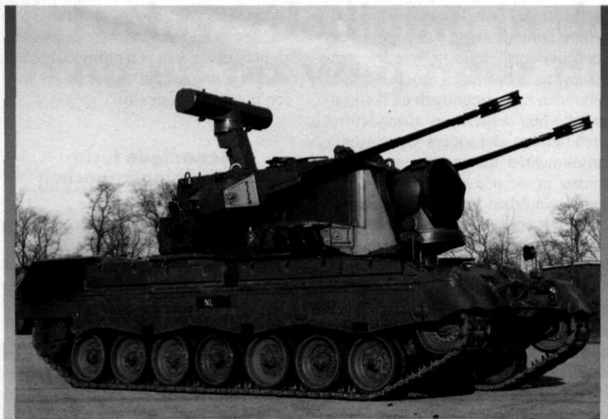
Afb. 1 Het wapensysteem PRTL, een 35 mm dubbelloops kanonsysteem op Leopard 1 onderstel dat in 1978 is ingevoerd ter beveiliging van de manoeuvre. Een ingrijpend verbeteringsprogramma voor de PRTL wordt thans voorbereid in een gezamenlijk programma met de Duitse landmacht. De eerste verbeterde PRTL'n zullen naar verwachting in 1998 instromen.
