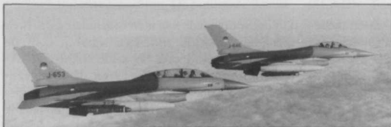
Afb. 6 Links een F-16 met AGM-65D (IR) Maverick, rechts een RF-16 met Orpheus-gondel
