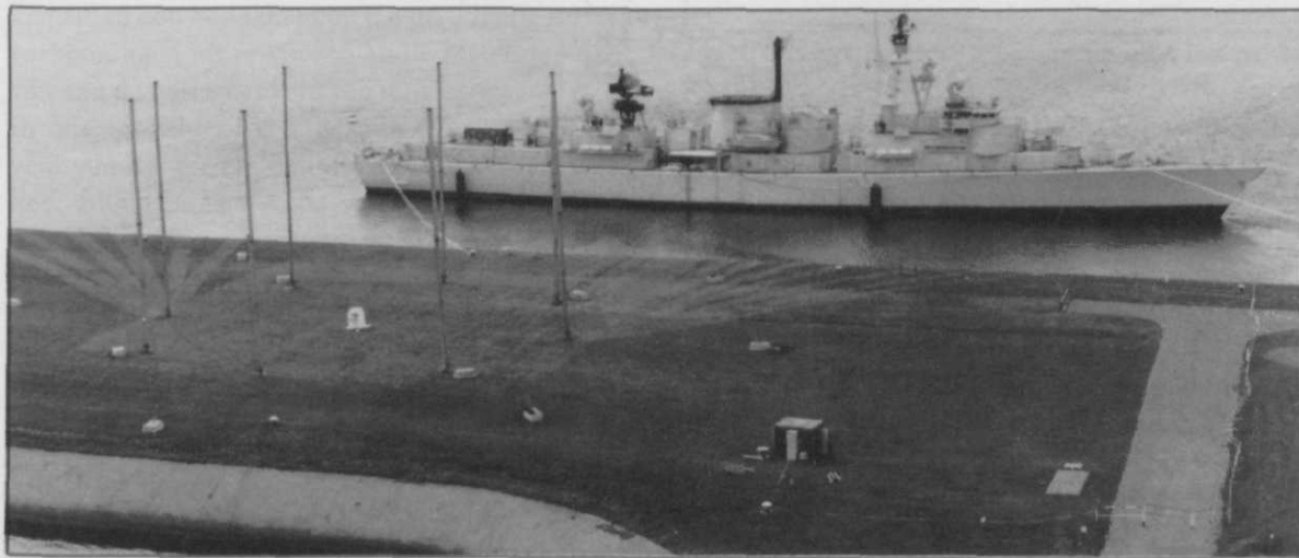
Afb. 8 De transportabele EMP-simulator EMIS-3/VPD van het FEL-TNO, opgesteld in Den Helder voor de beproeving van een marinefregat
