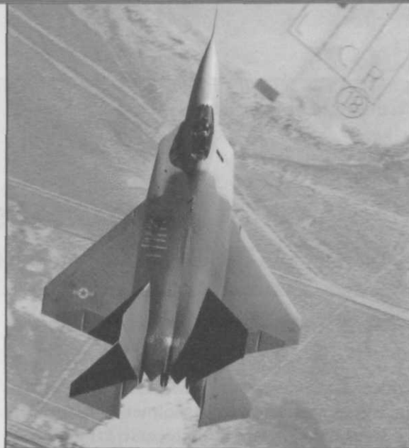
Het door Lockheed, Boeing en General Dynamics gezamenlijk ontworpen YF-22 Advanced Tactical Fighter (ATF) prototype toont de speciale rompvormen en motoruitlaten, die nodig zijn om het toestel zo min mogelijk zichtbaar te maken voor radar, infrarood en het blote oog; de opvolger van de F-16 zal zich ook door deze technologie moeten kenmerken
