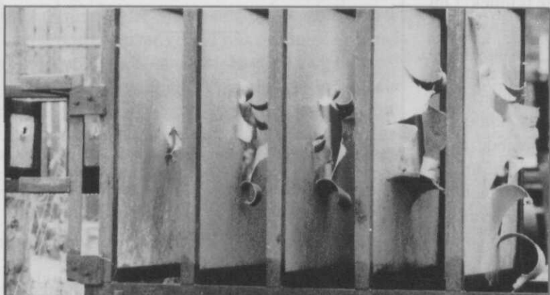
Afb. 5 Array van aluminiumplaten dat met het nieuwe 35 mm Frangible Armour Piercing Discarding Sabot (FAPDS) projectiel voor luchtdoelgeschut is beschoten; het projectiel kwam van links (een niet-opbrekend projectiel zou in elk van de platen slechts één klein gat hebben geslagen)
