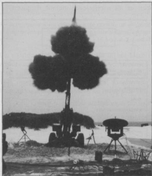
Schot! Houwitser 155 mm M114, L/39 verschiet obg nr 123E1 met kardoes nr 16E1 tij- dens de beproevingen (foto, en omslagfoto, beschikbaar gesteld door ir. T. Wijker) ▶
