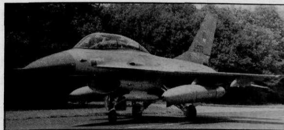
Klu-F-16, gemodificeerd met o.a. FLIR-pod en Wide angle HUD, tijdens NWX-proefnemingen in 1986/87
