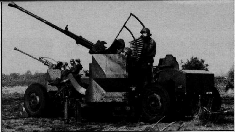
Afb. 5 De 40L70, nu nog tegen dreiging opgewassen, geschikt voor toekomstige dreiging over te lage vuursnelheid (foto De Vliegende Hollander)
