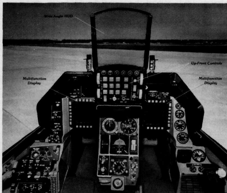
F-16 C/D cockpit met verbeterde indeling; videoschermen bieden de mogelijkheid snel en volledig een overzicht te behouden van zowel de gevechtssituatie, de bewapeningsopties als de essentieelste vluchtgegevens
