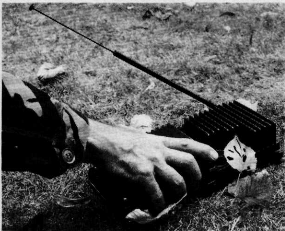
Afb. 8 Unattended expandable jammer, 20-90 MHz breedband-stoorzender; werkingstijd 2 uur, 10 W (Racal Comms Ltd)
