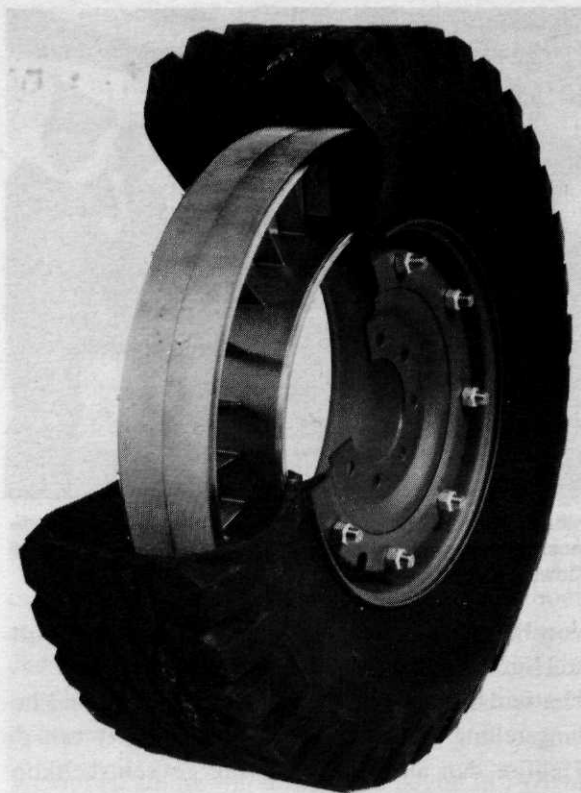
Afb. 12 Opengewerkt model van het „runflat” wielsysteem van de Goodyear/Moto Wheel Corporation; lekke of stukgeschoten banden vormen voortaan geen (militaire) problemen meer
