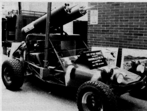
Afb. 11 Fast Attack Vehicle (FAV) van de firma Emerson Electric, hier bewapend met een dubbele lanceerinrichting, elk voor zeven 2,75 inch raketten tegen gronddoelen; het voertuig wordt beproefd in het kader van de nieuwe High Technology Light Division
