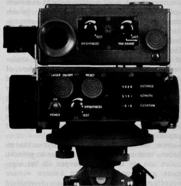
Afb. 8 De (mini) laserafstandsmeter (LAM)
