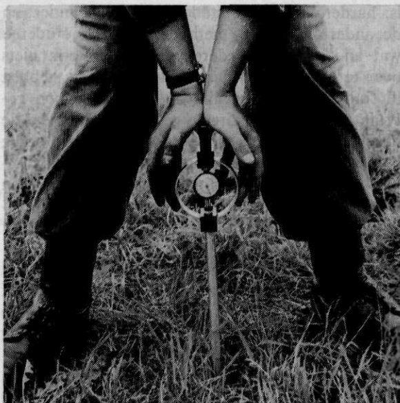
Afb. 3 De penetrometer, een apparaat om snel en handig de bodemweerstand te meten
