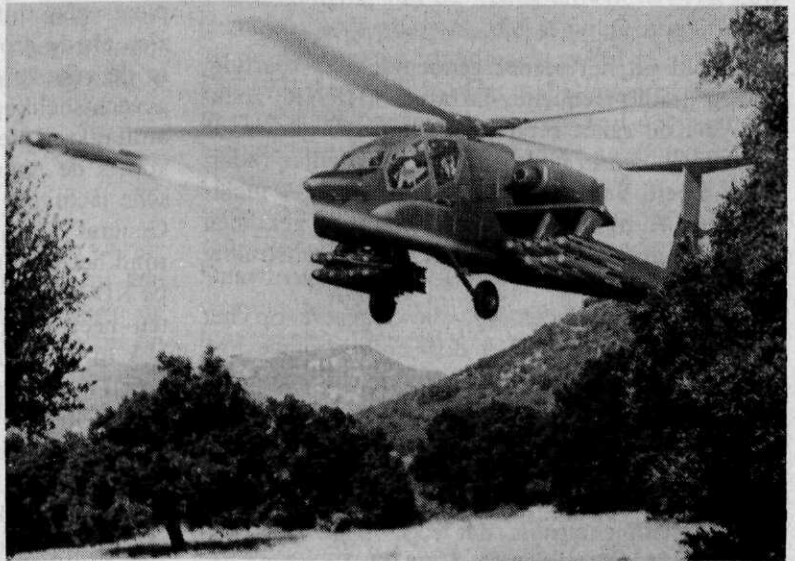
Afb. 3 Advanced attack helicopter YAH-64 van Hughes helicopters vuurt een Hellfire, met laser geleide anti-tankraket af met zichtdekking van de boomtoppen (scène uit een demonstratiefilm)
