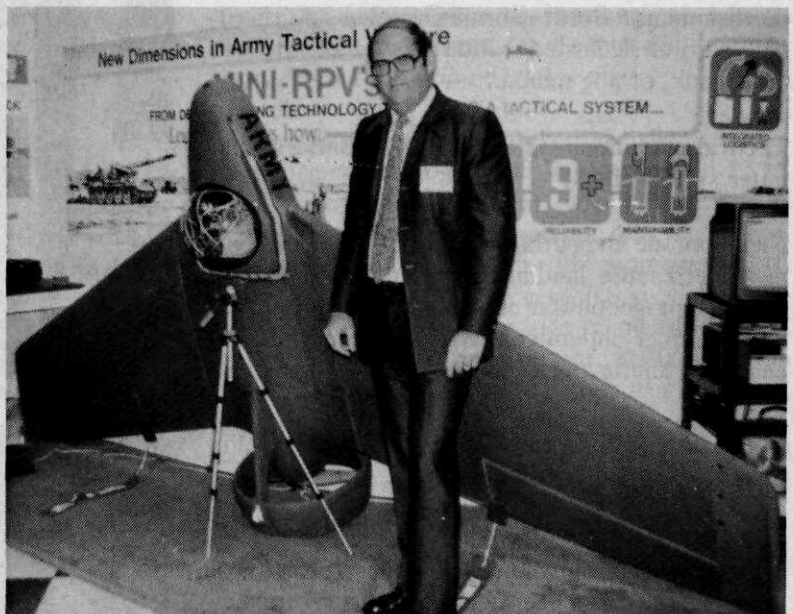
Afb. 9 Aquila mini remotely piloted vehicle (RPV) met aan de onderzijde de plastic koepel, waarin zich de laser-designator bevindt
