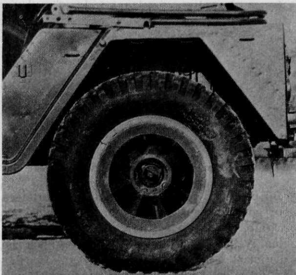
Afb. 22 Een in het wiel gebouwde centrifugaalpomp die het voertuig een betere propulsie te water geeft
