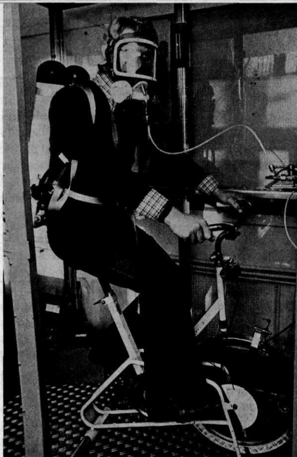
Afb. 6 Proefpersoon met overdrukpersluchtmasker op ergometerfiets
