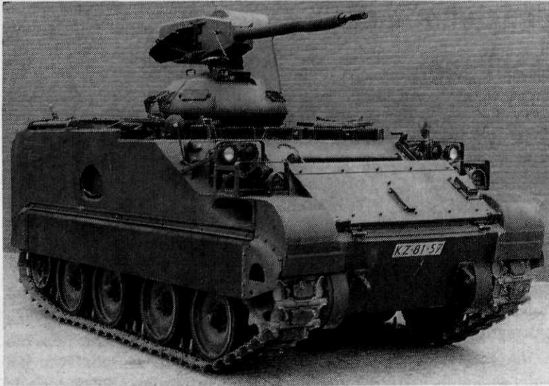
Het 25 mm wapensysteem op M113 C&V
