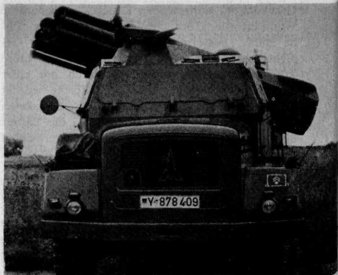
Abb. 4 Raketenwerfer 110 mm; 8 Werfer schießen in 20 Sekunden 288 Raketen
