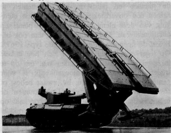
Afb. 5 Brugleggende tank op AMX30-chassis
