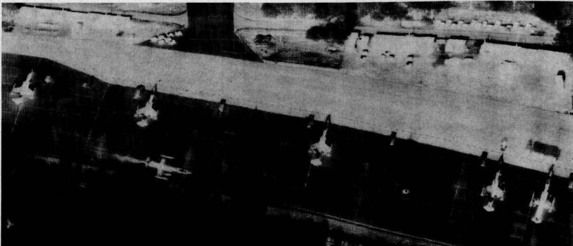
Afb. 17 Infraroodopname boven een vliegveld op 200 ft hoogte m.b.v. een 10-microndetector
