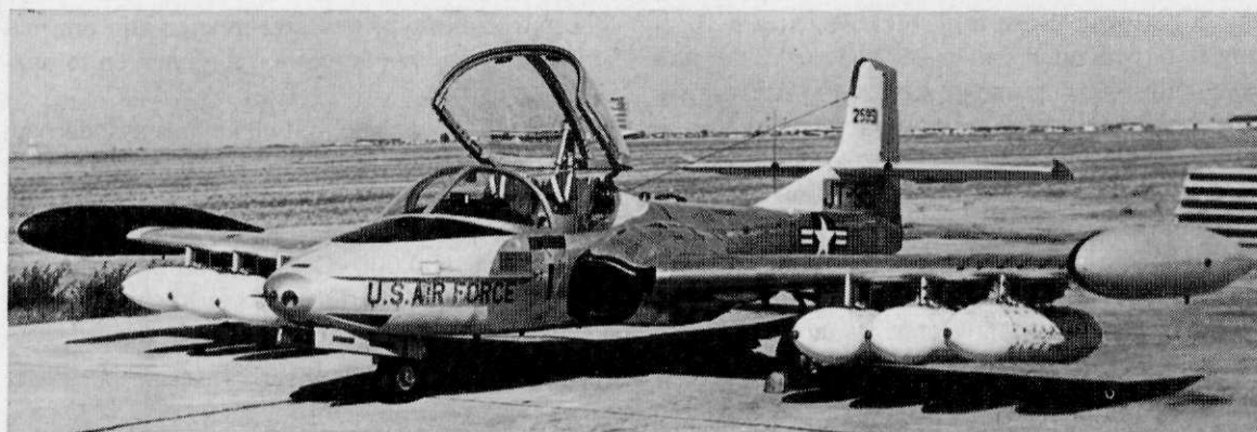
Afb. 2 Van de standaard-straaltrainer Cessna T-37 van de USAF is eveneens een COIN-versie gebouwd, de YAT-37E. Onder de vleugel kan deze machine een grote variëteit van bommen, raketten, napalm en wapengondels meevoeren. De YAT-37 is echter niet in serieproductie gekomen
