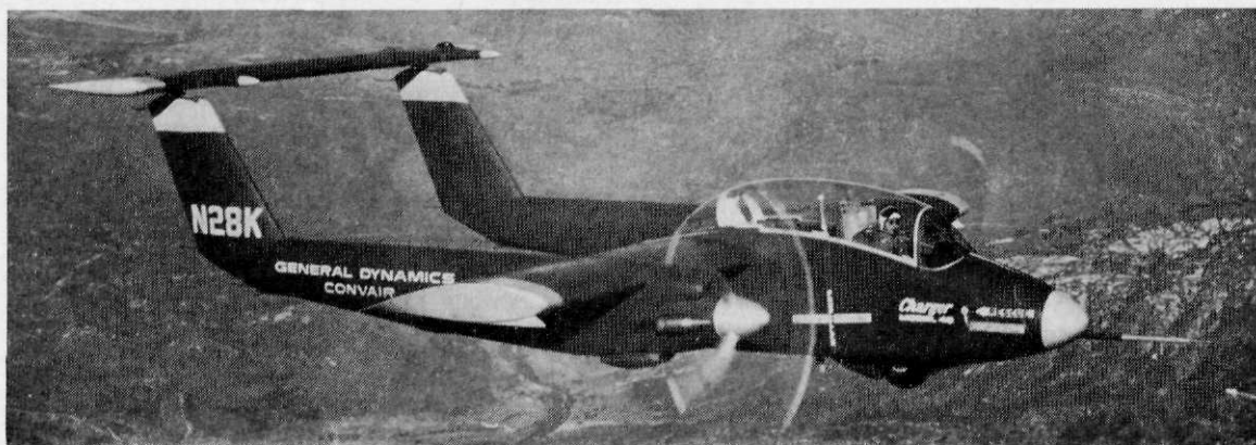
Afb. 4 Het prototype Charger in de vlucht. Een tweepersoons machine met tandemcockpit, voorzien van schietstoelen, twee staartbomen en hoog geplaatst stabilo. De motoren zijn schroefturbines
