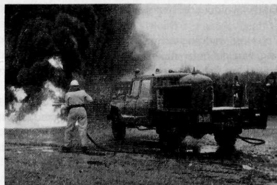
Afb. 1 Reddingsvoertuig, bemanning 4 personen, uitgerust met reddingsgereedschap en 750 kg bluspoeder (natriumbicarbonaat)
