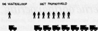
Afb. 5 Vergelijking van de relatieve technische krachtsinspanning voor het vernielen van de overgangen over een waterloop en het leggen van een 2 km lang standaard-mijnenveld
