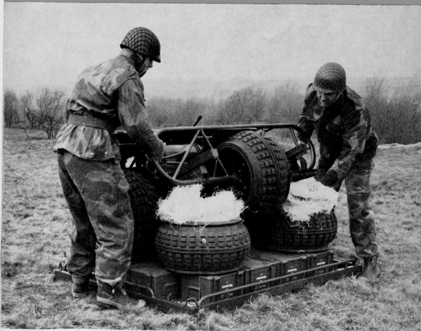
Modern luchtlandingsmaterieel: opvouwbare jeep met aanhanger
