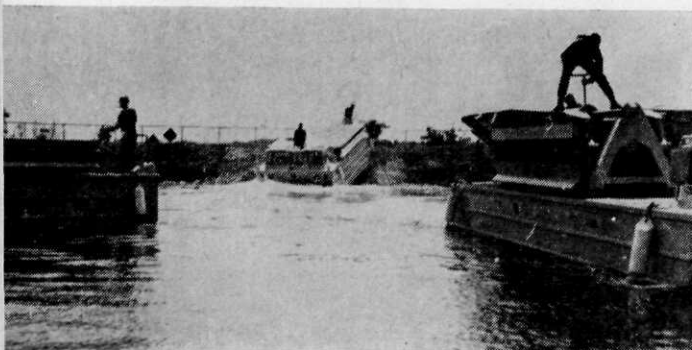
Afb. 11 MFAB, brugsectie gaat te water, voorbereidingen voor het koppelen met reeds varende elementen
