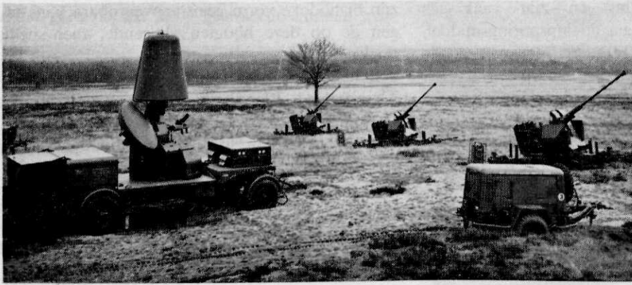
Opstelling van 3 stukken 40 mm lang 70 met L 415-radaruurleiding. Objectverdediging op legerkorpsniveau met mobiliteit legervoertuigen (foto Hollandse Signaalapparaten)
