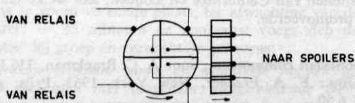
Afb. 15b Schema van de commutator
