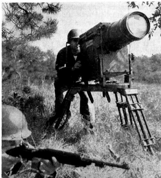
Afb. 4 Infrarood camera voor grote afstand.
