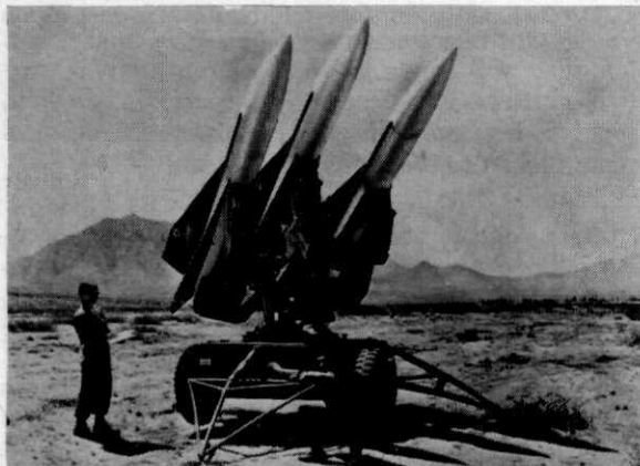
Afb. 4 „Hawk” geleid projectiel van de Amerikaanse lua op mobiele launcher. Het projectiel heeft een doelzoekend systeem, waarbij extra aandacht is geschonken aan de inzet op zeer geringe hoogten.
