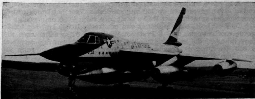
Afb. 1 Convair B-58 Hustler, Amerika's eerste supersonische bommenwerper; duidelijk zichtbaar onder de romp de enorme gondel voor het vervoer van A- en H-bommen of geleide projectielen.
