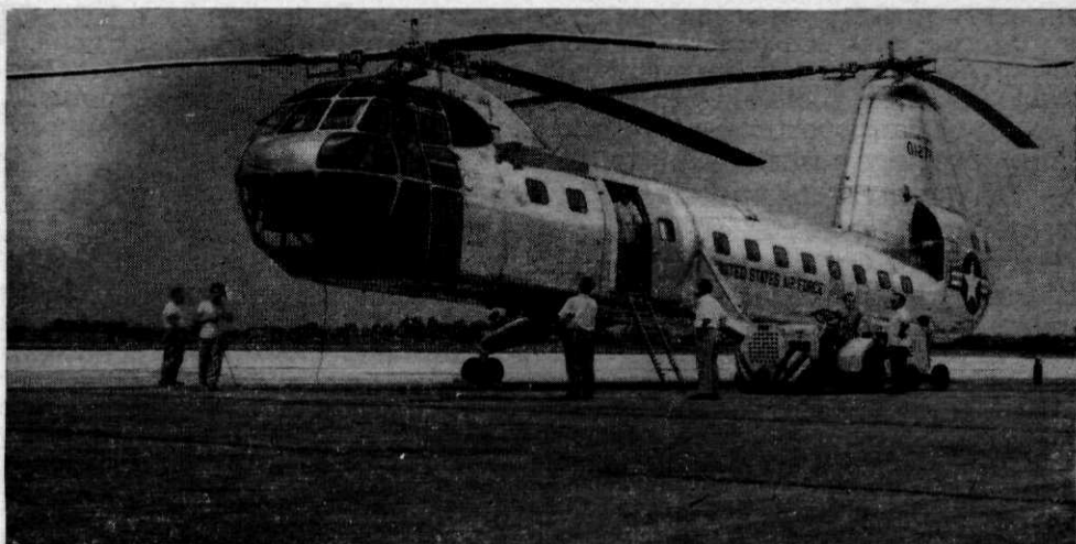
Afb. 1 Vertol (vroeger Piasecki) H-16 A Transporterrotor helicopter
