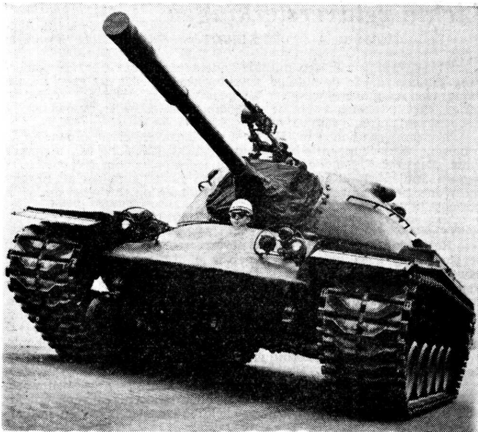
Een bijzonderheid van de nieuwe Amerikaanse middelzware tank, de Patton 48, de opvolger van de M-47, de Patton II, is het uit één stuk gegoten gietstalen lichaam met granaat afwerende vormen. Ook de koepel is een gietstalen gietstuk met een 90 mm snelvuurkanon en drie mitrailleurs
