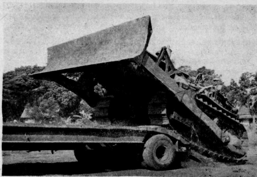
Afb. 4. Angledozer, klasse I (130 pk.) met hydraulisch bewogen blad. Over grote afstanden worden deze machines vervoerd op trailers. Op de foto rijdt de angledozer met eigen kracht op een 40-tons trailer.
