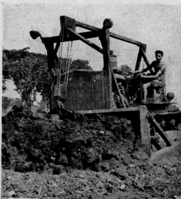
Afb. 5. Bulldozer, klasse II (92 pk.) Het blad staat loodrecht op de rijrichting en is niet verstelbaar. Het blad wordt bij dit type door kabels op en neer bewogen.
