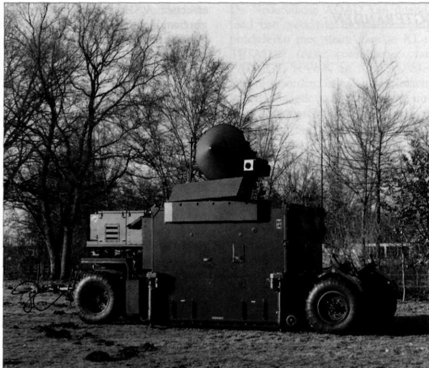
Afb. 6 Het radarvuurleidingssysteem Flycatcher, waaraan de KL twee kanonnen 40L70G koppelt
