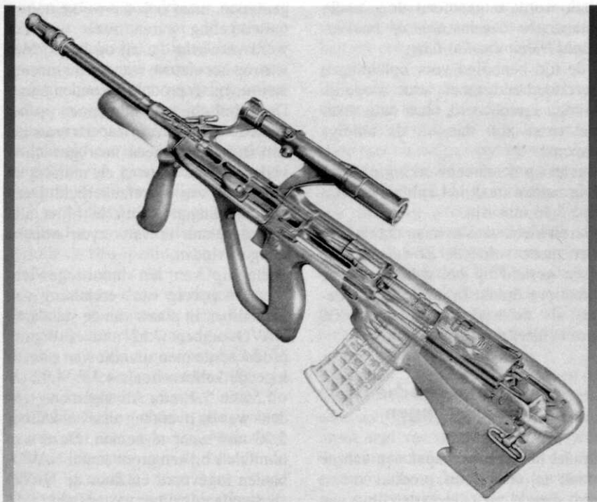
Afb. 2 Het „bullpup”-principe van de Steyr
