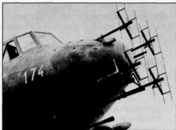
Afb. 1 In de zwaarbewapende neussectie van deze Dornier Do-217 bevindt zich de opvallende peilantenne van de Lichtenstein B/C boordradar.
