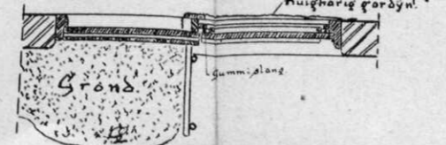
Gasdichte afsluiting van een gangbare dubbele deur.
